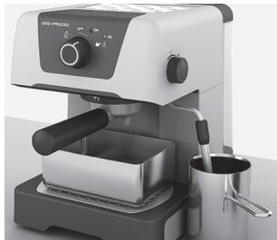
**2. Stellen Sie bei der erstmaligen Inbetriebnahme** eine Schüssel auf das Abtropfgitter. Wenn die grüne Anzeige leuchtet, ist der Heizvorgang abgeschlossen. Drehen Sie den Wahlschalter in die Position ☐ | ☰ und lassen Sie einen vollen Wassertank durch die Maschine laufen, um das Heizungssystem zu spülen.
