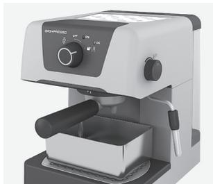
**2. Schalten Sie die Maschine ein** und heizen Sie sie auf. Stellen Sie eine Schüssel auf das Abtropfgitter. Drehen Sie den Wahlschalter in die Stellung und lassen Sie 1/3 der Lösung durch das System laufen. Warten Sie 10 Minuten in Stellung **ON**, stellen Sie eine Schüssel unter das Dampfrohr und drehen Sie den Dampfregler gegen den Uhrzeigersinn.
