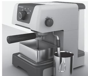
**3. Drehen Sie den Wahlschalter in Stellung** und lassen Sie wieder 1/3 durch die Dampfdüse austreten. Warten Sie 10 Minuten, drehen Sie den Dampfregler im Uhrzeigersinn und lassen Sie das letzte Drittel durch den Brühkopf fließen. Wiederholen Sie den Vorgang zweimal mit frischem Wasser, ohne Pausen.
