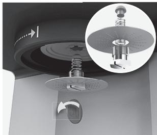
**1. Regelmäßiges Entkalken** abhängig von der Wasserhärte empfohlen. Nehmen Sie den Brühkopf ab (dabei Teile zusammen lassen) und füllen Sie dann den Tank mit Wasser/Entkalkungsmittel gemäß der Anleitung des betreffenden Produkts. **Achten Sie darauf, dass der Filter richtig festgezogen ist**, wenn Sie die Teile wieder einsetzen.
