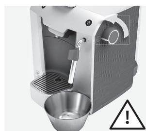
3. **Die Maschine darf nicht mit einem leeren Tank verwendet werden!** Wird sie zu lange ohne Wasser betrieben, kann die automatische Ansaugung blockieren. Stellen Sie zur **Wiederinbetriebnahme** einen Behälter unter das Heißwasserrohr und drehen Sie den Knopf auf die Position „Dampf/Heißwasser“. Sobald aus dem Rohr ein kontinuierlicher Strahl austritt, drehen Sie den Knopf wieder zurück.
