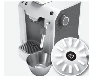
**1. Entkalken.** Wir empfehlen Ihnen die Maschine, je nach Wasserhärte, regelmäßig zu entkalken (2-3 Monate). Wir empfehlen die Electrolux Entkalkungslösung EPD4/C/D/E/N/R zu verwenden (benutzen Sie auf keinen Fall Essig). Wassertank entnehmen und entleeren. Füllen Sie den Entkalker in den Wasserbehälter (befolgen Sie die Anweisungen des Herstellers).
