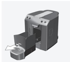
**2. Wenn der Schwimmer über dem Abstellgitter sichtbar ist, muss die Auffangschale geleert werden.** Nehmen Sie das Gitter, und die Auffangschale heraus. Leeren, spülen und trocknen Sie die Teile und setzen Sie sie wieder ein. Dieser Vorgang sollte alle zwei bis drei Tage oder nach 10 gebrühten Kaffees wiederholt werden. Die Auffangschale ist nicht spülmaschinenfest.
