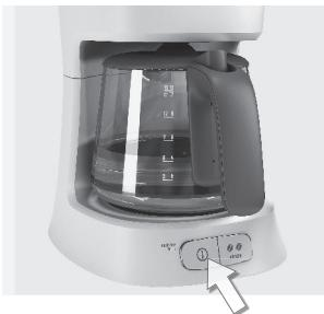
**4. Die Kaffeekanne mit der Abdeckung auf die Wärmeplatte stellen. Den Entkalker ca. 15 Minuten lang einwirken lassen und dann die Maschine einschalten. Die Maschine ausschalten, sobald die Lösung vollständig durchgelaufen ist. Den Entkalkungsvorgang bei Bedarf wiederholen.**
