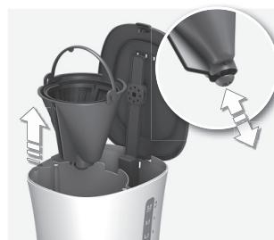
**2. Zum Reinigen des Filterhalters** den Griff anheben und den Filterhalter herausnehmen. Um das Filterventil gründlich zu reinigen betätigen Sie dieses mehrmals während des Abspülens. Die Filterhalterung kann auch im Geschirrspüler gereinigt werden.
