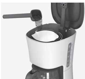
**4. Einen Papierfilter der Größe 1x4 in den Filterhalter einlegen** und mit Kaffeepulver füllen. Neben der Wasserstandsanzeige befindet sich die empfohlene Kaffee-Messlöffelangabe. Für einen durchschnittlich starken Kaffee reicht ein Messlöffel voll (ca. 6–7 g) pro Tasse. Die Abdeckung des Wassertanks schließen und Kaffeekanne (mit Deckel) einsetzen.
