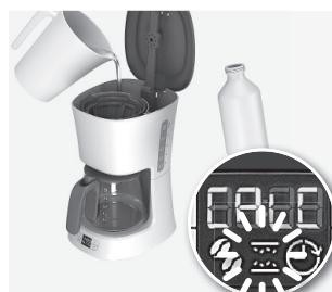
**3. Entkalken.** Nach 150 Brühvorgängen zeigt das Display „CALC“ an, um darauf hinzuweisen, dass eine Entkalkung zu diesem Zeitpunkt empfohlen wird. Drücken Sie eine beliebige Taste, um die Meldung zu löschen. Füllen Sie den Behälter mit Wasser und der auf dem Produkt angegebenen Menge Entkalker und führen Sie die Schritte 4 und 5 aus.
