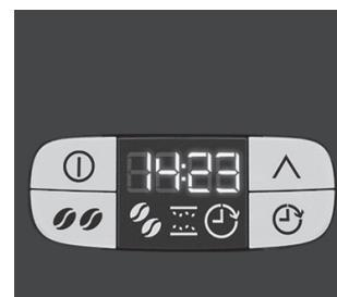
**6. Prüfen, Ändern oder Löschen der Zeitvorwahl.** Drücken Sie zur Anzeige der Zeitvorwahl die Taste . Drücken Sie zur Einstellung einer neuen Zeitvorwahl erneut die Taste . Ändern Sie die Zeit. Drücken Sie zur Bestätigung . Drücken Sie zum Löschen der Zeitvorwahl die Taste . Das Display zeigt 10 Sekunden lang OFF und danach wieder die aktuelle Uhrzeit an.
