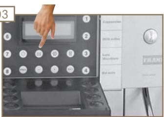
Wassertank entfernen bzw. Wasseranschluss schliessen. Spültaste mindestens 3 Sekunden lang drücken, um das Flüssigkeitssystem zu entleeren.
