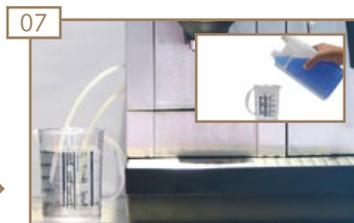
30 ml (eine Einheit) Milchreiner mit einem halben Liter kaltem Wasser im Reinigungsbehälter vermischen. Die Milchschläuche in den Reinigungsbehälter einführen.
