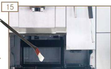
Gehäuse des Satzbehälters reinigen.
