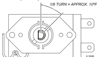
Fig. 11 Adjust Thermostat
