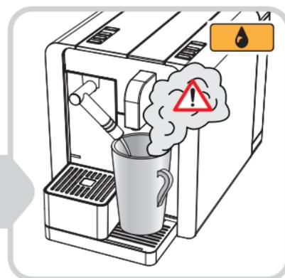
Нажмите **кнопку очистки**
