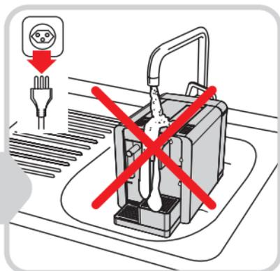
Перед каждой очисткой отключайте машину от сети! Никогда не погружайте машину в воду и не мойте под проточной водой
