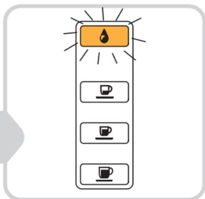
Произведите **очистку молочной системы**: как только резервуар для молока установлен, кнопка очистки
