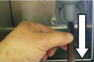
**2** Flansch gegen den Uhrzeigersinn drehen und Mixer ausbauen.
