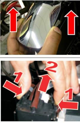
**2** Cappuccinatore aus dem Kaffeeauslauf ausbauen. Silikonschlauch No. 3 und No. 4 entfernen.
