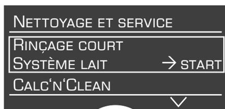
Un pré-nettoyage automatique du système lait 10 peut être effectué.
