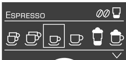
Nella riga di stato **5a** del display **5** viene visualizzato il nome del tipo di bevanda e il valore impostato per l'intensità, ad esempio  $\emptyset\emptyset$  e per la quantità, ad esempio
