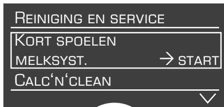
Het melksysteem **10** kan automatisch worden voorgereinigd.
