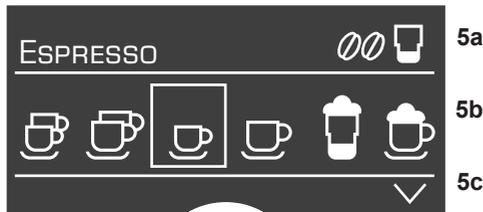
In de regel “status” **5a** van het display **5** wordt de naam van de drank en de ingestelde sterkte, bijv. 00, en hoeveelheid, bijv. 1, vermeld. In de regel “keuze” **5b** verschijnen symbolen voor de drankkeuze. De pijltjes in de regel “navigatie” **5c** geven aan in welke richting er zich nog menuniveaus bevinden.
