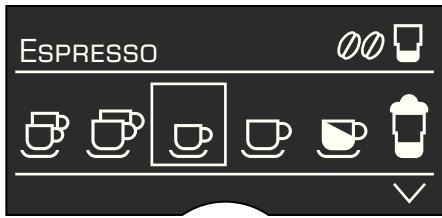
Nella riga di stato **5a** del display **5** viene visualizzato il nome del tipo di bevanda e il valore impostato per l'intensità, ad esempio **00** e per la quantità, ad esempio **■**. La riga di selezione **5b** rappresenta i simboli per la selezione delle bevande. Le frecce nella riga di navigazione **5c** indicano in quale direzione sono disponibili ulteriori livelli di menu.
