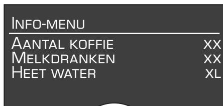
Door de toets **i 7** nogmaals kort in te drukken, keert u terug naar de drankkeuze. Wordt gedurende ca. 10 seconden geen toets bediend, dan keert het apparaat automatisch weer naar de drankkeuze terug.
