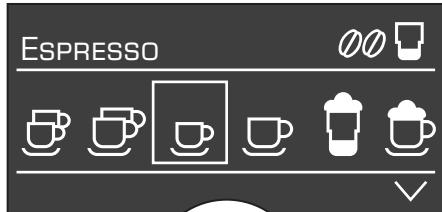
Nella riga di stato **5a** del display **5** viene visualizzato il nome del tipo di bevanda e il valore impostato per l'intensità, ad esempio **00** e per la quantità, ad esempio **■**. La riga di selezione **5b** rappresenta i simboli per la selezione delle bevande. Le frecce nella riga di navigazione **5c** indicano in quale direzione sono disponibili ulteriori livelli di menu.
