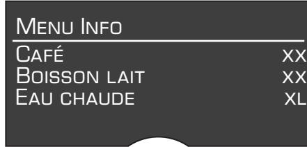
Appuyer brièvement sur la touche **7 i** pour revenir à la sélection de boissons. Après env. 10 secondes sans confirmation, la machine se replace automatiquement en mode de sélection des boissons.
