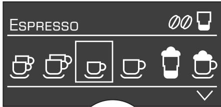
In de regel "status" **5a** van het display **5** wordt de naam van de drank en de ingestelde sterkte, bijv. **00**, en hoeveelheid, bijv. **cup**, vermeld. In de regel "keuze" **5b** verschijnen symbolen voor de drankkeuze. De pijltjes in de regel "navigatie" **5c** geven aan in welke richting er zich nog menu-items bevinden.
